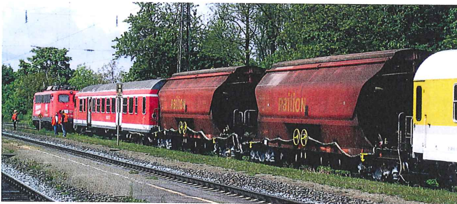
Messzug zur fahrtechnischen Prüfung der mit dem DRRS25L ausgerüsteten Güterwagen
